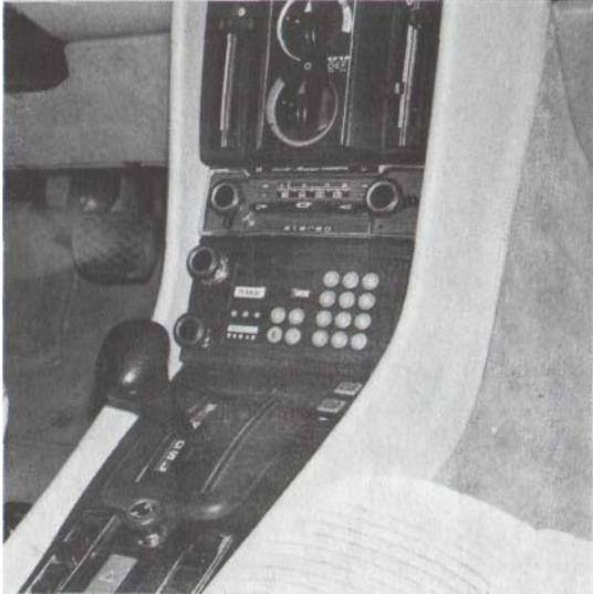
**Das Bediengerät** der BSA 22 wurde neu entwickelt, so daß nunmehr aufgrund der fahrzeuggerechten Abmessungen (siehe Bild) auch bei diesem Fabrikat die bisherigen Einbaueinschränkungen aufgehoben werden können und eine Unterbringung in all unseren Typen möglich ist.
